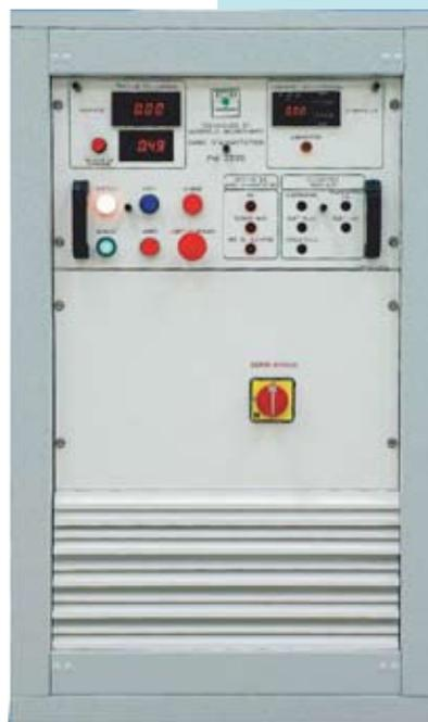
min. et max. de cette intensité par un jeu de roues codeuses situées en face avant de la baie. Un comparateur commande un relais si l'intensité est comprise entre les deux seuils.
